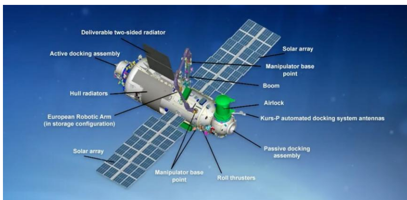
Schema del modulo Nauka con il braccio robotico (European Robotic Arm). Crediti: NASA TV/Spaceflight Now
