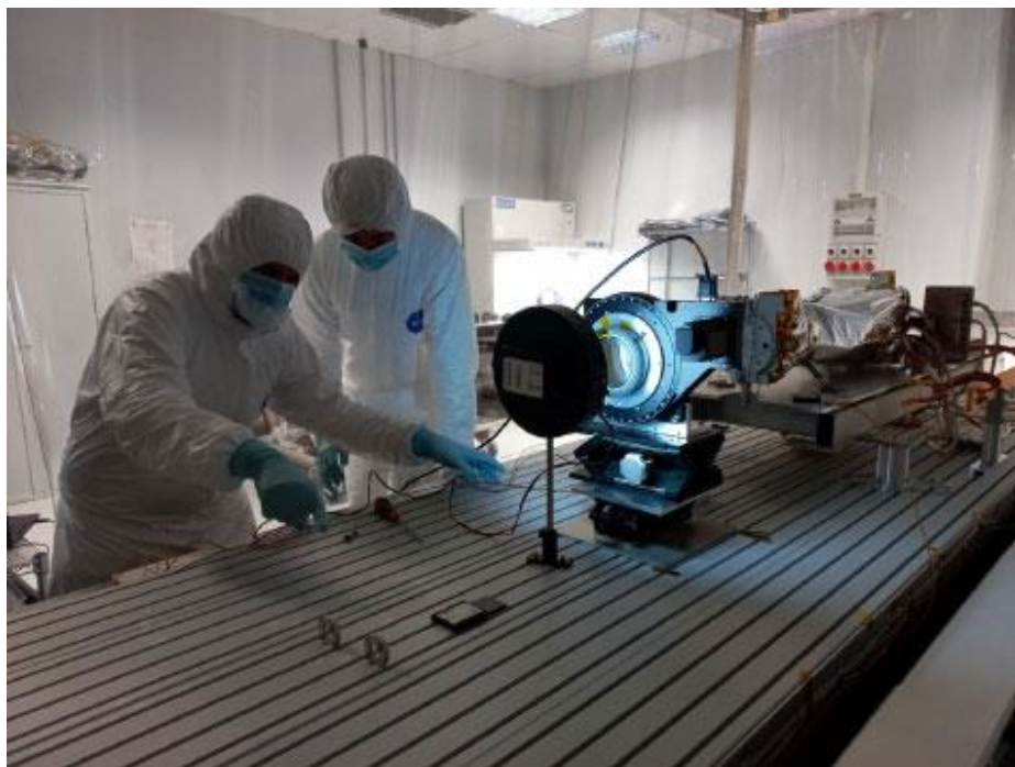
Lo strumento Aspiics nel Laboratorio spaziale Inaf "Optical Payload Systems" durante le calibrazioni del telescopio e degli Sps. Crediti: Inaf
