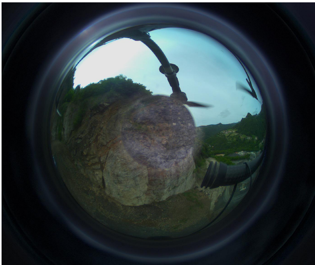
Immagine acquisita da uno degli occhi PanCam della DaedalusCam durante i test a bordo del drone, che mostra la vista panoramica e la regione centrale ad alta risoluzione. Crediti: Emanuele Simioni
