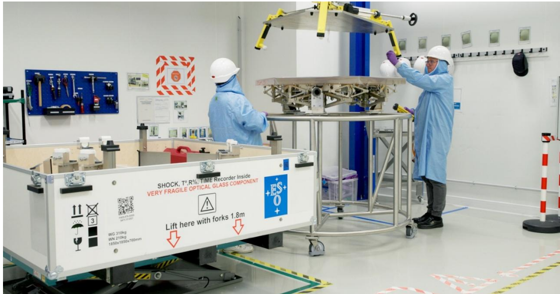
Questa foto, scattata nel settembre 2026 presso lo stabilimento di Safran Reosc vicino a Poitiers, mostra un segmento lucidato di M1 che sta per essere sollevato e inserito nel contenitore di trasporto. Crediti: ESO
